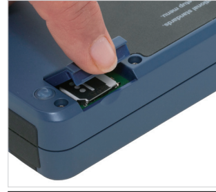
図23.4 - SIMカードを挿入
